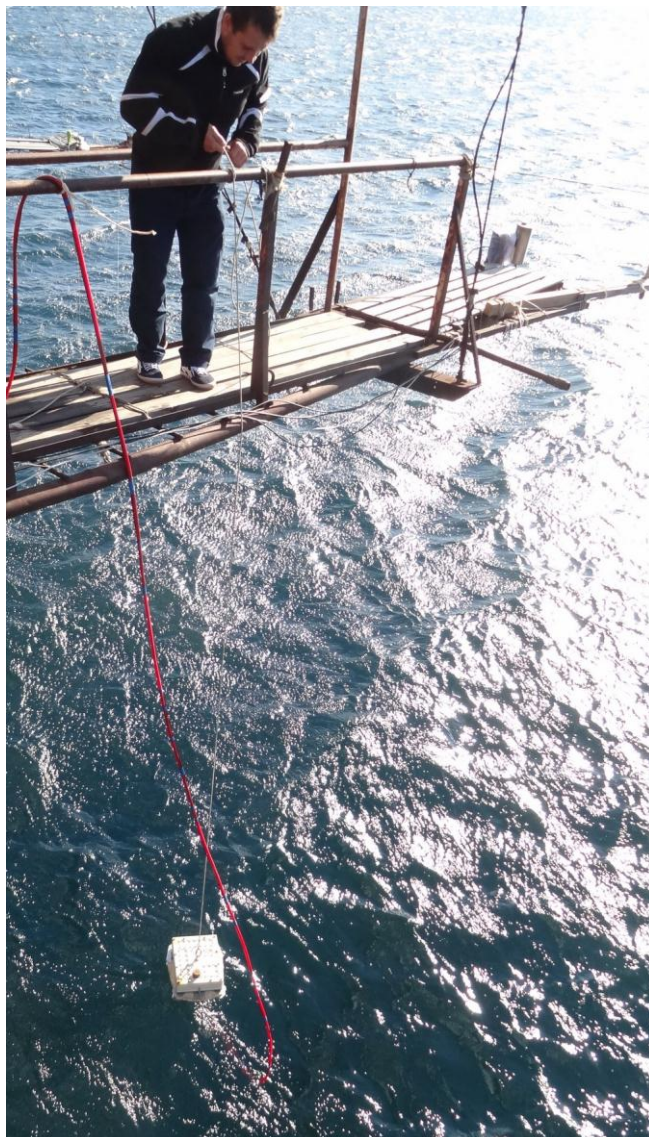
Рис. 3.18. Погружение подводного акустического волнографа на глубину 25 м.
