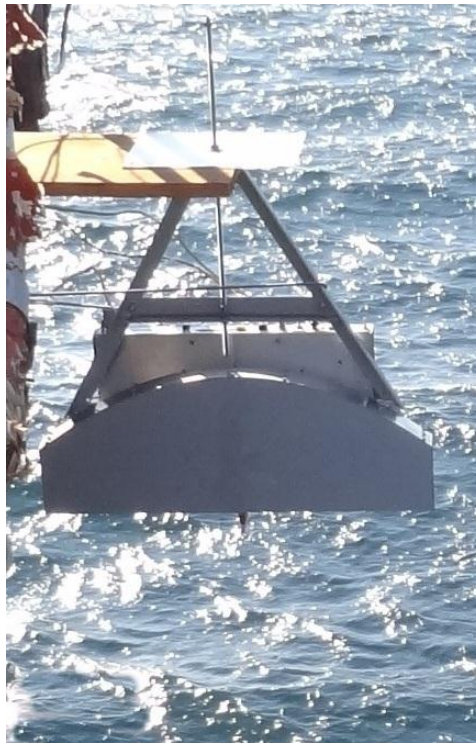
Рис. 3.31. Доплеровский радиолокатор Ka-диапазона с ножевой диаграммой направленности антенны
