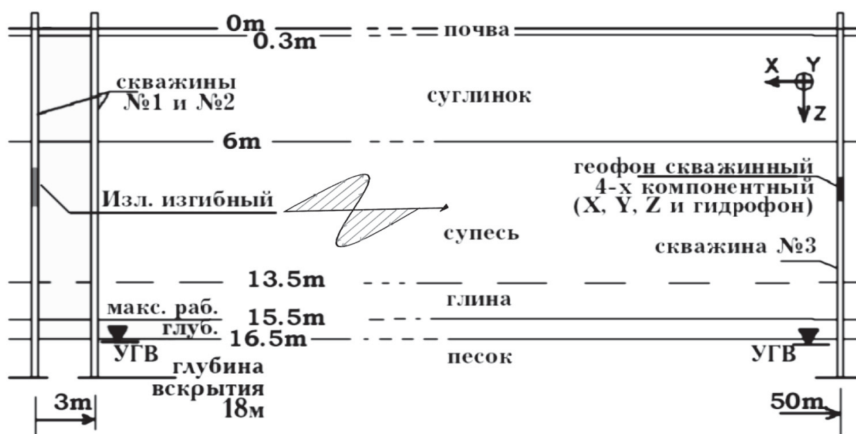
Рис. 3.1. Геометрия эксперимента и примерная структура среды. Схематично показаны направление распространения и вектор смещения в SH-волне.
