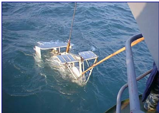
Буксируемый антенный комплекс на базе широкополосных излучателей электродинамического типа
