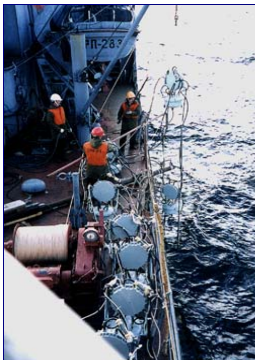
Постановка 16-элементной вертикальной излучающей антенны для селективного возбуждения мод в мелководном канале (эксперимент в Баренцевом море)
