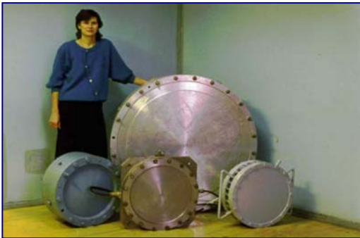
Излучатели электромагнитного типа для частот от 70 до 600 Гц (слева и в середине); прототип излучателя для арктических исследований, частота 20 Гц (справа)
