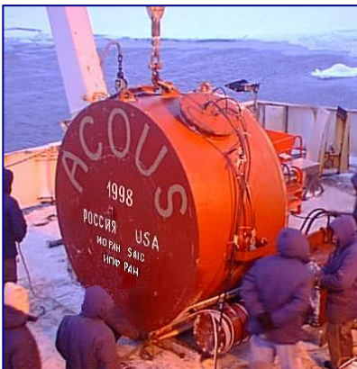
Автономный излучающий комплекс ИПФ РАН для долговременных исследований по акустической термометрии океана (российско-американский проект ACOUS, Северный Ледовитый океан, частота 20.5 Гц)
