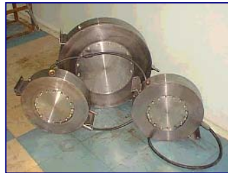
Излучатели электромагнитного типа для частот от 70 до 600 Гц (слева и в середине); прототип излучателя для арктических исследований, частота 20 Гц (справа)
