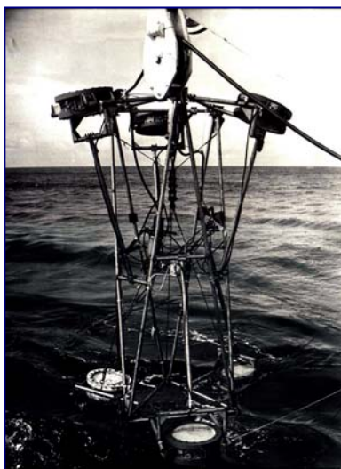
Объемная шестиэлементная излучающая антенна (рабочая частота 235 Гц, уровень излучения на оси диаграммы направленности 223 дБ), использовавшаяся при проведении экспериментов по дальнему распространению звука в Атлантическом океане
