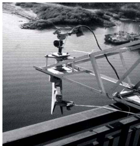
Радиолокатор с ножевой диаграммой направленности антенны
