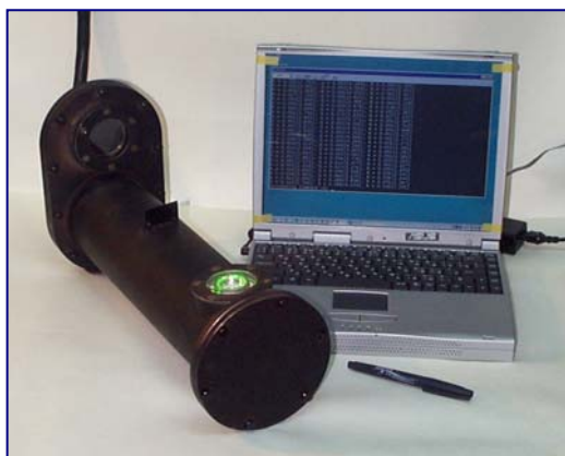
Прибор TURBIDO для измерения показателя рассеяния морской воды ( \sigma ) на трех длинах волн (475, 525 и 590 нм) в широком диапазоне значений \sigma = 0.05 \text{ м}^{-1} \div 3 \text{ м}^{-1} .
