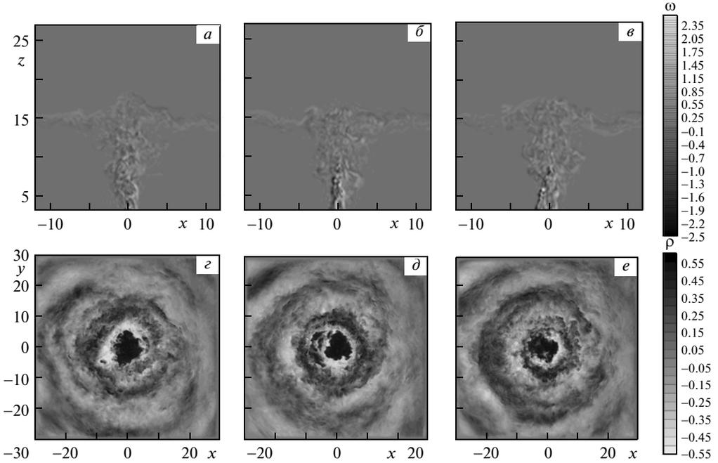
Фиг. 3. Распределение компоненты завихренности  $\omega$ , в центральной плоскости  $(x, z)$  в моменты времени  $t = 1440, 1485, 1530$  (а–в) и отклонения плотности  $\rho$  от ее среднего значения на горизонте пикноклина в горизонтальной плоскости  $(x, y)$  при  $t = 1530, 1620, 1710$  (г–е);  $Fr(0) = 11$
