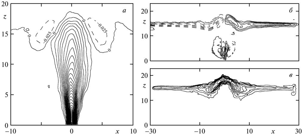
Фиг. 2. Распределения средних вертикальной  $\langle U_z \rangle$  (а) и горизонтальной  $\langle U_x \rangle$  (б) компонент скорости и среднеквадратичных флуктуаций плотности  $\rho'$  (в) в центральной плоскости  $(x, z)$  для числа  $Fr(0) = 15$ : инкременты изолиний: а–в – 0.025; 0.01; 0.04
