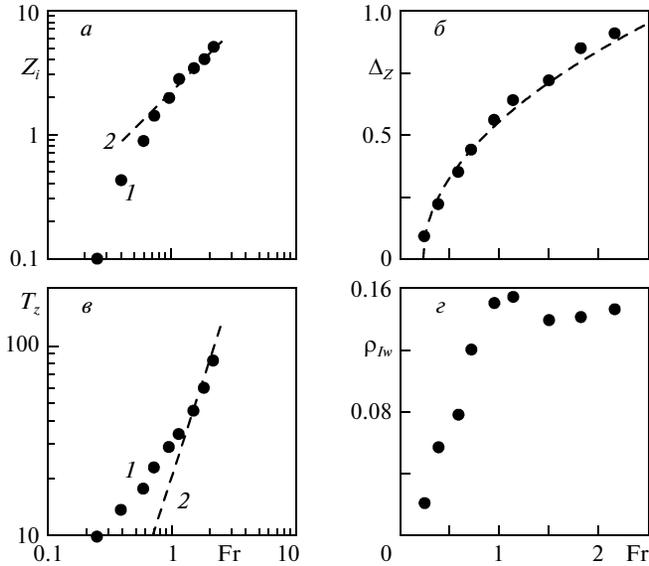
Фиг. 5. Зависимости от  $Fr(12)$  высоты фонтана  $Z_m$  (а), дисперсии смещения изопикны  $Z_{\rho=1.5}$  в области верхушки фонтана  $\Delta_Z$  (б), периода осцилляций  $T_z$  колебаний изопикны  $Z_{\rho=1.5}$  (в) и амплитуды внутренних волн  $\rho_{IW}$  (г): 1 –  $Z_m$ , 2 –  $Fr$  (а); 1 –  $T_z$ , 2 –  $Fr^2$  (в)
