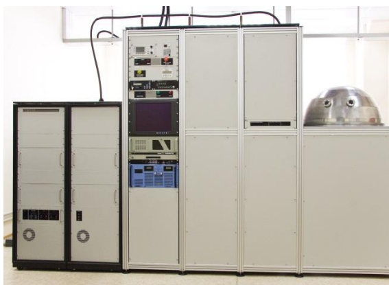
СВЧ реактор для синтеза алмаза из газовой фазы
