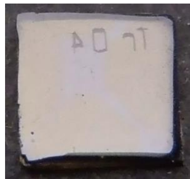
Фотография эпитаксиального слоя алмаза, выращенного со скоростью 120 мкм/час
