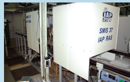
Импульсный прототип нейтронного генератора на основе сильноточного ЭЦР ионного источника SMIS 37
