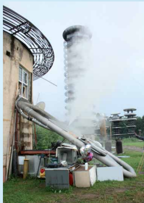
Генератор заряженного облака водного аэрозоля на высоковольтном стенде в городе Истра
