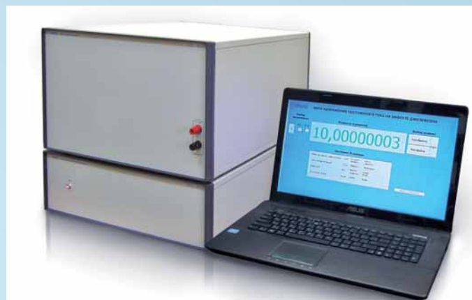
Рабочий образец прибора для эталонного измерения напряжения с встроенным криоохладителем замкнутого цикла
