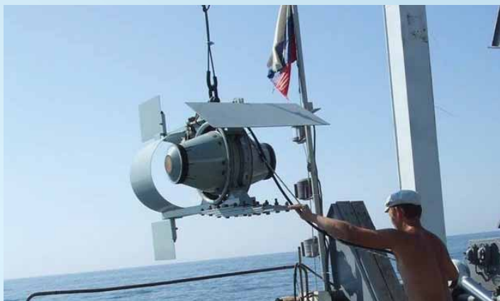
Спуск гидроакустического излучателя за борт судна в ходе экспериментов по когерентной морской сейсмоакустике в Каспийском море
