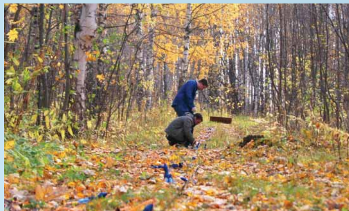
Постановка антенны сейсмических приемников. Полигон ИПФ РАН «Безводное»
