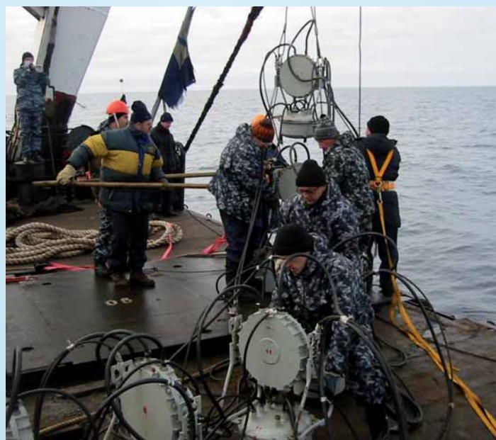
Ответственный момент — постановка в рабочее положение излучающей антенны, разработанной в ИПФ РАН для выполнения экспериментов по когерентной акустике мелкого моря
