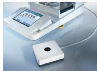
В зависимости от потребностей пользователя и применяемых весов, соединение с компьютером производится с помощью различных интерфейсов (в т. ч. RS-232 и RS-485).
