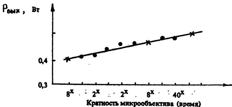
Рис. 36. Зависимость средней мощности пучка, несущего усиленное изображение, от параметров объектива на входе системы
