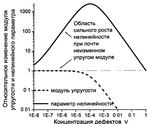
Рис. 2. Относительные изменения модуля упругости E_{\text{eff}}/E и параметра квадратичной нелинейности \gamma_{\text{eff}}^{(2)}/\gamma^{(2)} микронеоднородной среды, содержащей дефекты с типичным для трещин показателем относительной мягкости \zeta = 10^{-4} .
