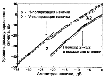
Рис. 9. Амплитуда демодулированного сигнала как функция амплитуды сдвиговой волны накачки при ее горизонтальном распространении для вертикальной ( V ) и горизонтальной ( H ) поляризации. Четко видно амплитуды перехода показателя степени 2 \rightarrow 3/2 (отмечены стрелками) при переходе в режим «хлопания» слабых контактов. Для V -поляризации в силу анизотропии нагруженности контактов переход происходит при большей амплитуде, а уровень детектированного сигнала, соответственно, ниже, чем для H -поляризации накачки [31].
