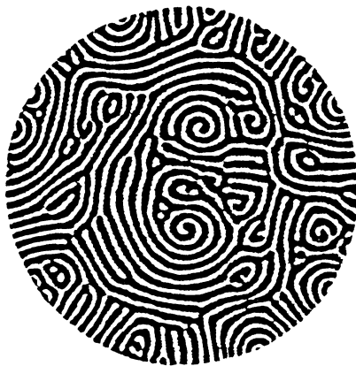
Рис. 1.14. Теневая картина конвекции Рэлея–Бенара при низких числах Прандтля. В двумерном поле контраста изображения присутствуют топологические особенности типа спиралей, дислокаций и дисклинаций
