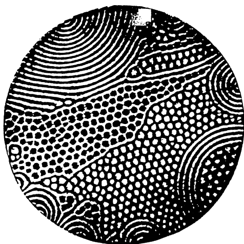
Рис. 8.2. Домены с топологически разными структурами при конвекции Рэлея–Бенара в системе, близкой к точке перехода газ–жидкость
