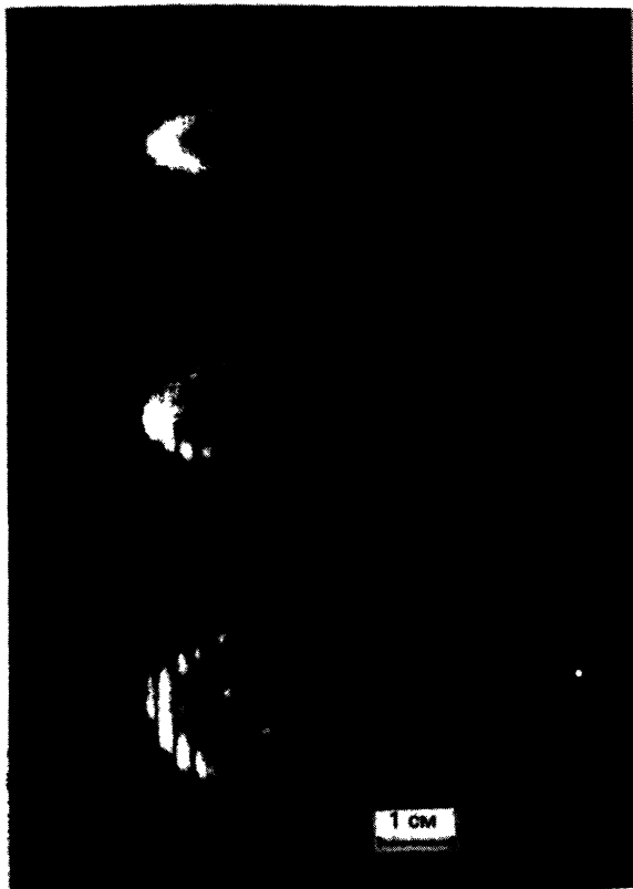
Р и с. 28 Эволюция разряда в области \nu > \omega , p = 70 Торр: а — t = 30 мкс, б — 36 мкс, в — 50 мкс
