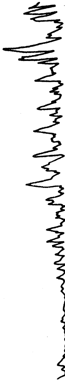
Р и с. 7. Пример записи рассеянного на МИИТ сигнала при регистрации его приемной аппаратурой с разной чувствительностью
