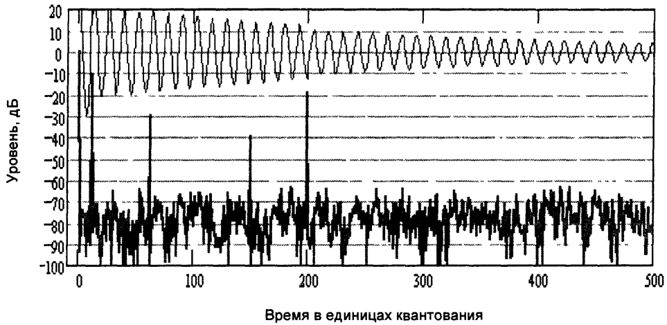
Рис. 3.8. Отклик локатора. Вверху в линейном масштабе показан отклик локатора на узкополосный зондирующий импульс, внизу – результат обработки этого отклика путем расширения его спектра (дБ).
