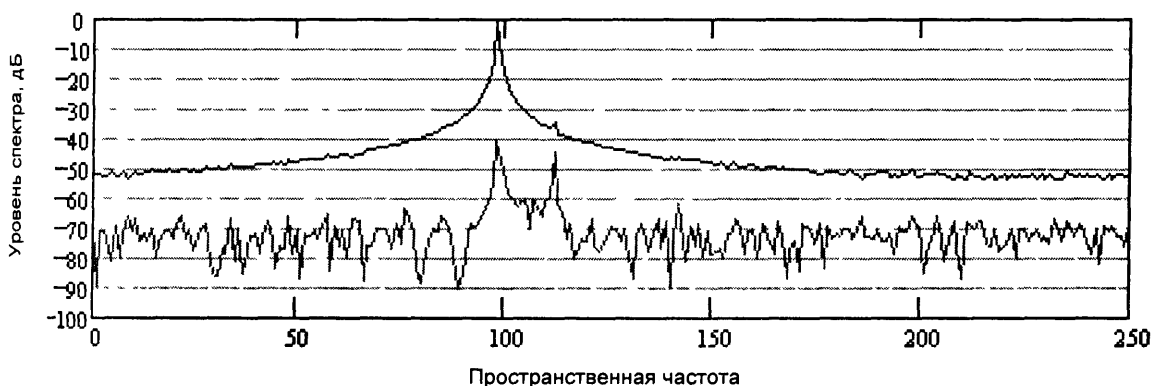
Рис. 2.6. Устранение узкополосной помехи методом темного поля. Сверху показан результат обычного спектрального анализа, внизу — результат анализа этого же сигнала методом темного поля.
